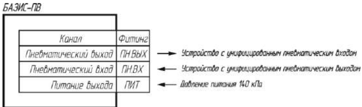
Рис. Б.5. Типовая схема подключения пневматических внешних устройств к исп. БАЗИС-ПВ.42 Контроллера
